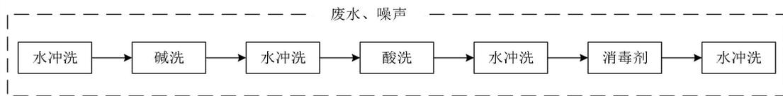
图 2-2 CIP 清洁工艺流程及产污节点图
