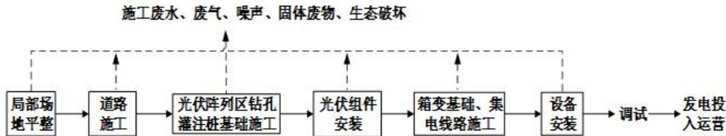
图 4-1 施工期工艺流程及产污节点图
