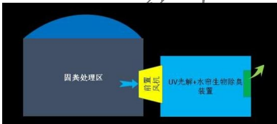
图 3.5-1 UV 光解+水帘生物除臭系统示意图
